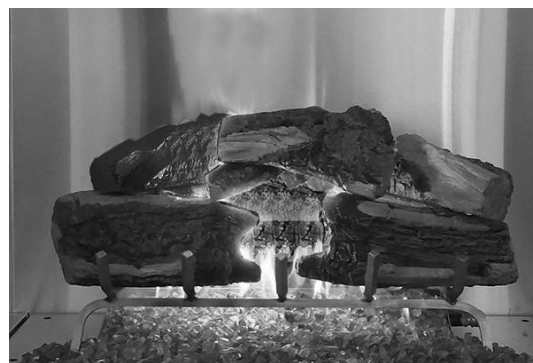
Le schéma 8 - Modèle incorrect de flamme de brûleur provoqué par blocage de port
