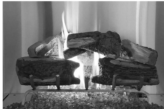
Le schéma 7 - Modèle correct de flamme de brûleur
