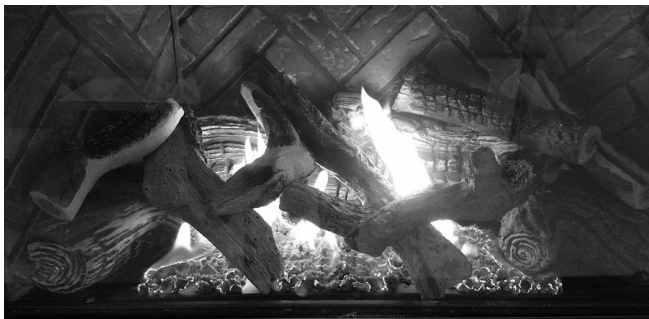
Schéma 53 - L'aspect de la flamme du brûleur
