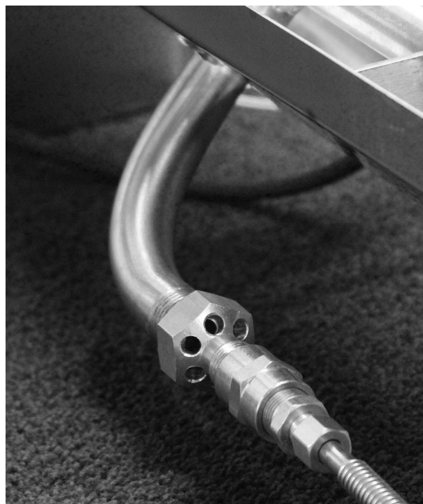
Figure 10 -Support d'injecteur sur le tube de brûleur à débouché
