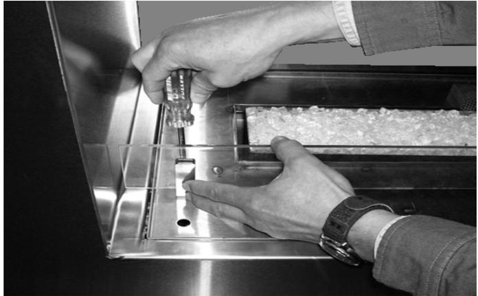
2. Remplissez le plateau des média fournis. Ne placez pas de média sur le brûleur ou bloquez l'écoulement d'air entre le brûleur et le plateau.
