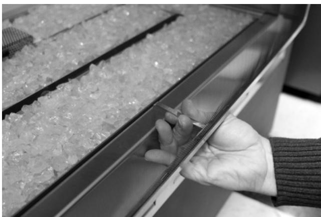
Tout en tenant l'écran d'une main, utilisez l'autre main pour plier légèrement l'onglet central, puis continuez de faire tourner l'écran vers l'avant jusqu'à ce que l'onglet central puisse être verrouillé dans la fente comme indiqué.
