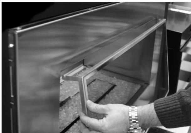
Placez l'extrémité supérieure de l'écran dans l'ouverture du foyer en utilisant les encoches sur les deux languettes latérales supérieures.
