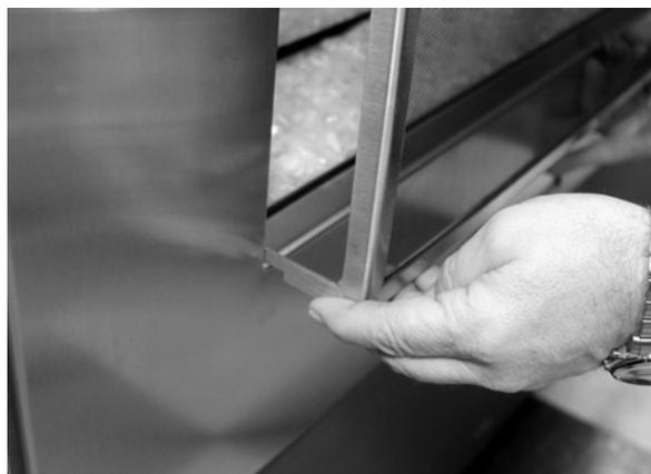
Si nécessaire, plier légèrement les languettes du bas gauche et droit vers l'intérieur, pour permettre à l'écran de se reposer à l'intérieur de l'ouverture du foyer.
